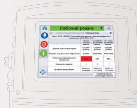
Интерфейс CLARiTY™ моделей 1550 и 1650 позволяет просматривать детализированную информацию о неисправностях в удобной и понятной форме, что дает возможность выявлять наиболее серьезные проблемы и основные причины незапланированных простоев.
