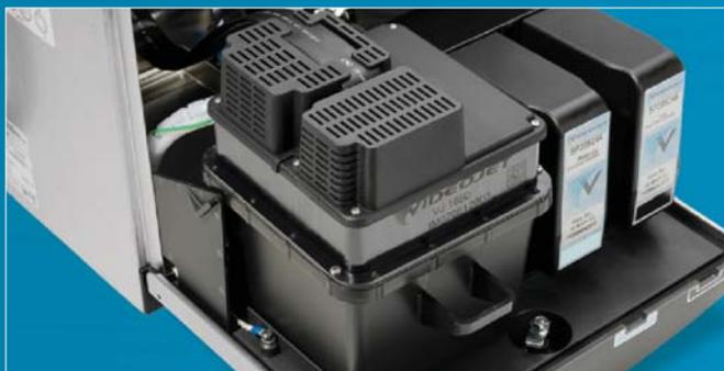
**Чернильный модуль.** Усовершенствованная конструкция чернильного модуля обеспечивает до 14 000 часов непрерывной работы между плановым техническим обслуживанием. Заказчик в состоянии самостоятельно осуществить замену чернильного модуля, причем все фильтры и изнашиваемые детали являются его неотъемлемой частью.
